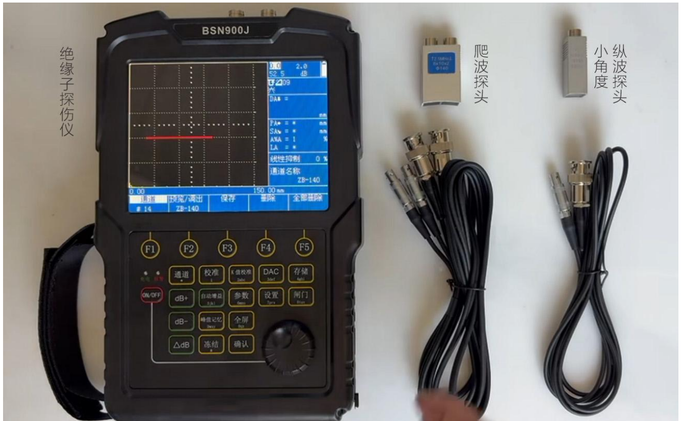
认识绝缘子探伤仪主机、爬波探头、小角度纵波探头
