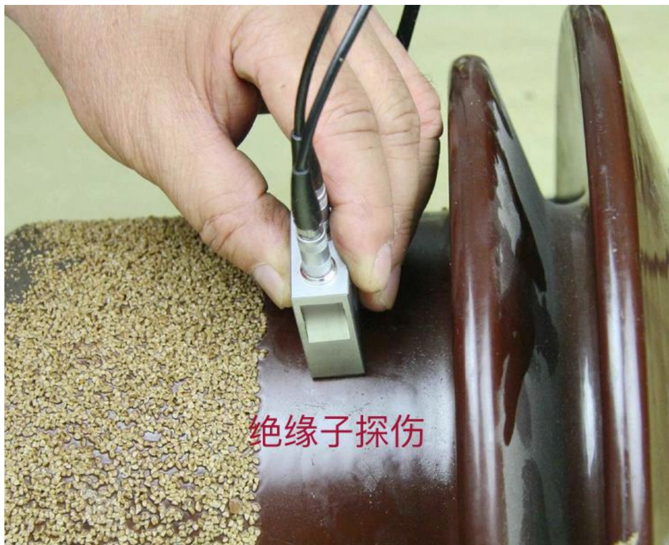
支柱瓷绝缘子探伤实操照片
